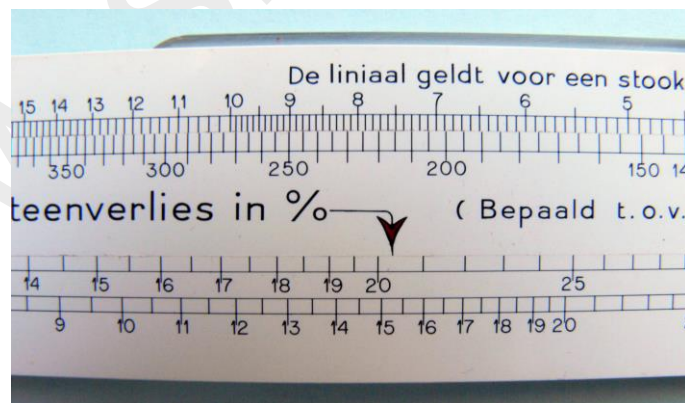
Fig. 4: instelling om het schoorsteenverlies te controleren
