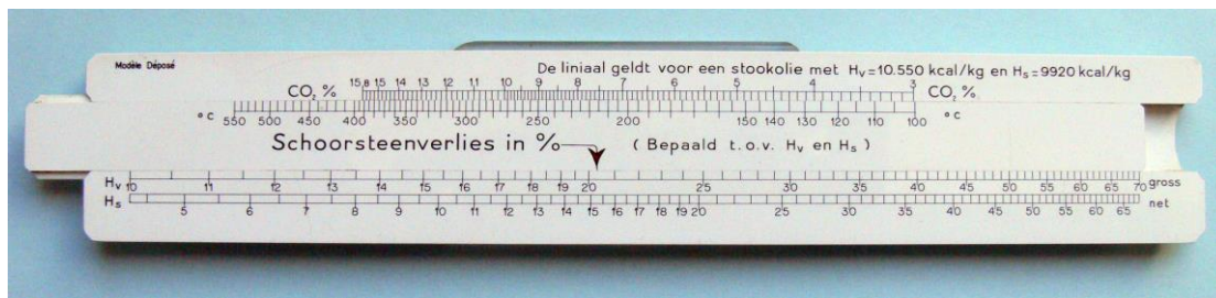
Fig. 2: Shell Stookrekenliniaal - achterzijde en schuifbaar tong
