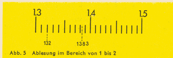
Abb. 5 Ablesung im Bereich von 1 bis 2
