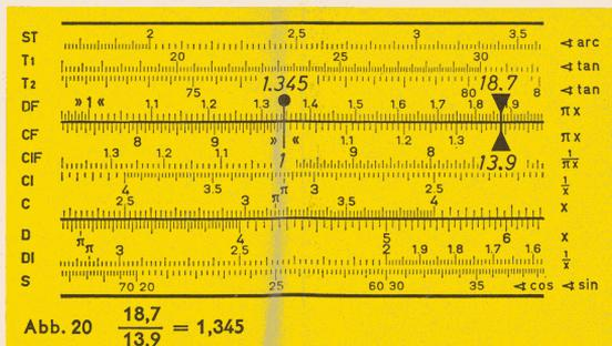
Die Division mit den Skalen CF und DF bringt den Vorteil, daß der Zähler wie bei der Bruchschreibweise oben in Skala DF und der Nenner darunter in CF eingestellt wird. Das Ergebnis steht sowohl in Skala DF als auch in D gegenüber der entsprechenden 1 in CF bzw. C.
