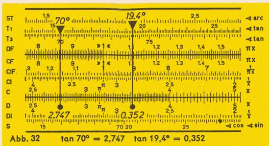
Abb. 32 zeigt die Einstellung für  $\tan 19,4^\circ$  in Skala T1 und  $\tan 70^\circ$  in Skala T2.
