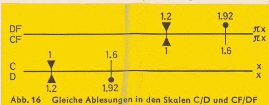
Dabei ist zu beachten, daß die Zungenskala C über der Skala D, die Zungenskala CF dagegen unter DF steht. Um Einstellfehler zu vermeiden, sind die Skalen C und CF gelb gefärbt.
