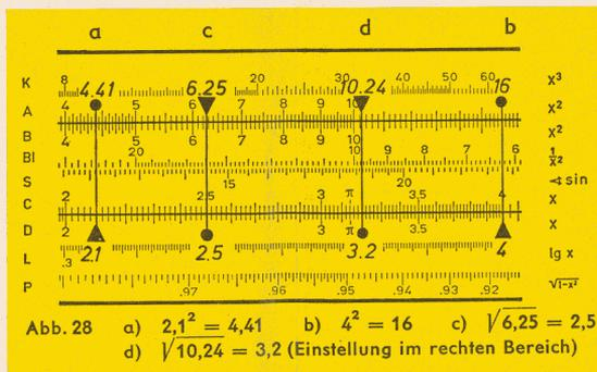
Beim Rechnen mit den Quadratskalen ist es vorteilhaft Zehnerpotenzen abzuspalten, um die Kommastellung bzw. die Einstellung im richtigen Bereich sicherzustellen. Es kommt immer darauf an, Zahlenwerte zu erhalten, deren Quadrate oder Quadratwurzeln leicht zu übersehen sind. Das geschieht am besten, indem wir uns die Bezifferung der Skalen zunutze machen und in D nur Werte von 1 bis 10, bzw. in A von 1 bis 100 einstellen. Deshalb werden alle anderen Zahlen auf solche Werte reduziert.
