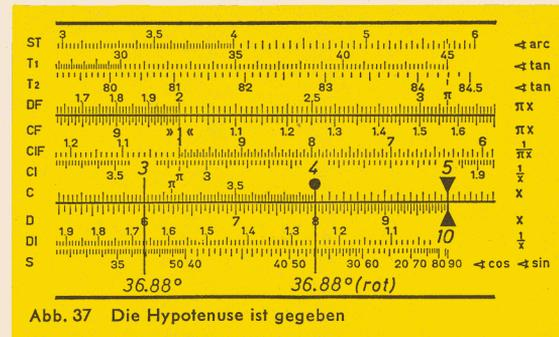
Entsprechend verfahren wir, wenn eine Kathete und ein Winkel gegeben sind, indem das Sinusverhältnis aus der Kathete und dem gegenüberliegenden Winkel mit den Skalen S und C eingestellt wird. Gelegentlich ist es vorteilhafter, mit der Skala CF anstelle von C zu rechnen, um das
