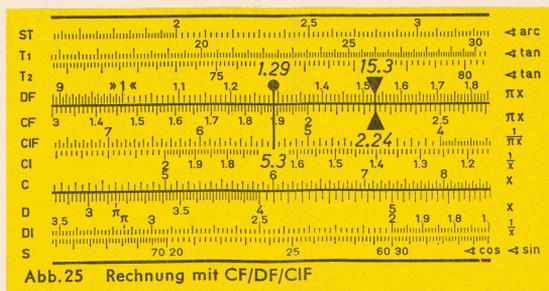
Nach der Division  $15,3:2,24$  wird 5,3 in Skala CIF mit dem Läufer eingestellt und das Ergebnis 1,29 in Skala DF abgelesen.
