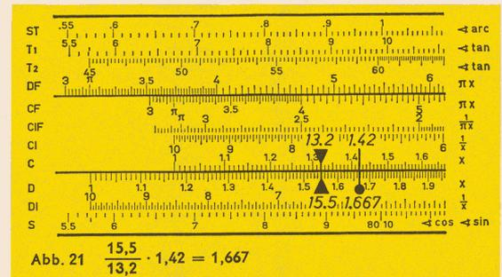
**Grundsatz:** Zuerst dividieren, dann multiplizieren ohne Ablesen des Zwischenergebnisses. Nach der Division steht die Zunge immer in der Ausgangsstellung für eine anschließende Multiplikation.
