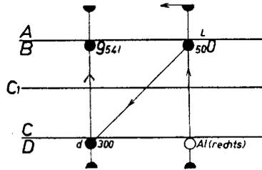
Bemerkung: Über allen auf D eingestellten Durchmessern  $d$  steht auf B das zugehörige Gewicht der Länge  $L$ . Die Marke „Al rechts“ entspricht den Konstanten des Gesetzes ( $\gamma_{\text{Al}} = 2,7$ ).
