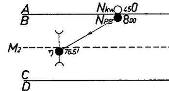
Bemerkung:  $\eta$  ist auf der Dynamoseite abzulesen; dementsprechend sind die Teilungen so zu wählen, daß der kleine Zeiger in den Bereich der richtigen  $\eta$ -Teilung kommt. Bei falscher Einstellung kann man sich durch Verschieben der Zunge um eine 10-Teilung helfen.
