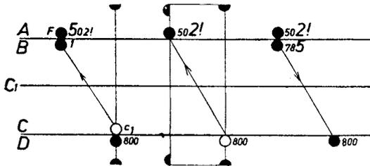
Bemerkungen: Die Marken  $c$  und  $c_1$  sind beliebig zu benutzen;  $c$  entspricht dem Wert  $\sqrt{\frac{4}{\pi}} = 1,128$ ;  $c_1$  dem Wert  $\sqrt{\frac{10}{\pi \cdot 4}} = 3,57$ . Der Abstand des schwarzen Mittelstriches vom linken roten Strich des Läufers entspricht 1,128. Die Strichmarke 785 entspricht dem Wert  $\frac{\pi}{4}$ . Die Aufgabe wird am bequemsten mit den Läuferstrichen gelöst.
