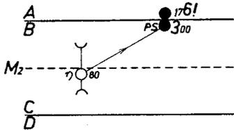
mechanisch zugeführte Leistung  $N_{PS} = 30$  PS und deren Wirkungsgrad  $\eta = 80\%$  gegeben ist.
