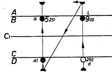
Den Widerstand  $R$  einer Rundaluminium-Leitung von einem Durchmesser  $d = 2,5$  mm und einer Länge  $L = l_1 + l_2 = 900$  m zu ermitteln.
