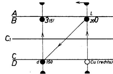
Bemerkung: Über allen auf D eingestellten Durchmessern  $d$  steht auf B das zugehörige Gewicht der Länge  $L$ . Die Marke „Cu rechts“ entspricht den Konstanten des Gesetzes ( $\gamma_{\text{Cu}} = 8,9$ ).
