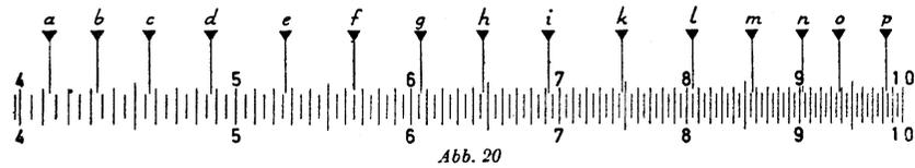
Suchen Sie die Werte auch auf Ihrem Rechenschieber auf und versuchen Sie, diese mittels des Läufers möglichst genau einzustellen!
