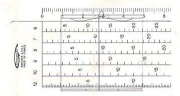
Cet instrument permet de déterminer rapidement le corps le plus approprié pour réaliser une composition typographique de dimensions données.
